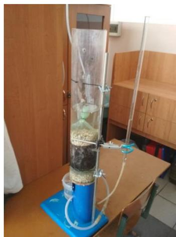
**Рис. 7. Общий вид установки для исследования сорбционной емкости брикетированного торфа в динамических условиях**
