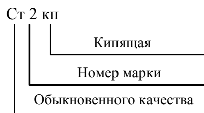
Рис. 2.23. Марка конструкционной стали обыкновенного качества
