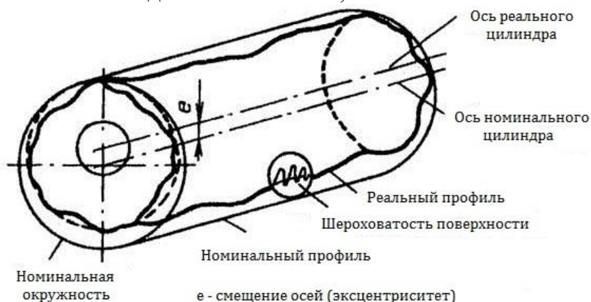
Рисунок 1.1 - Искажение размеров и формы цилиндра после изготовления
