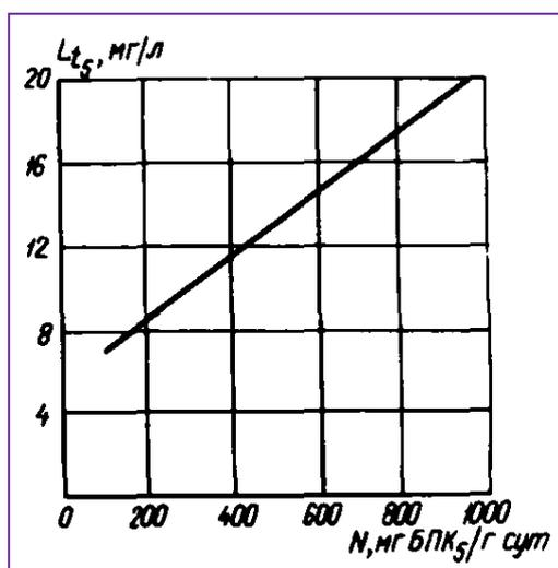
Рисунок 1 – Зависимость БПК<sub>5</sub> очищенной сточной воды ( $L_{t_5}$ ), отстоянной в течение 2 ч пробы, от нагрузки на ил ( $N$ )
