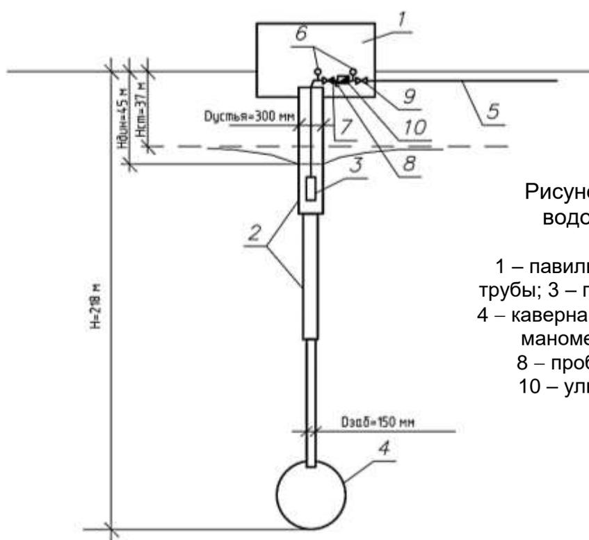
Рисунок 2 – Схема скважины водозабора «Граевский»:
