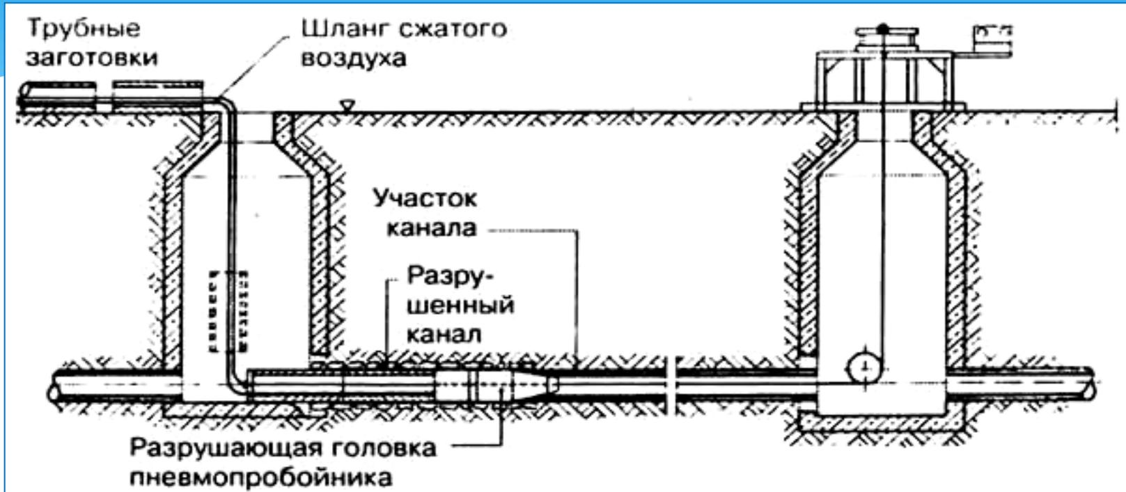
Рисунок 86 – Схема санации методом продавливания (протаскивание трубопроводов на места старых с их предварительным разрушением)
