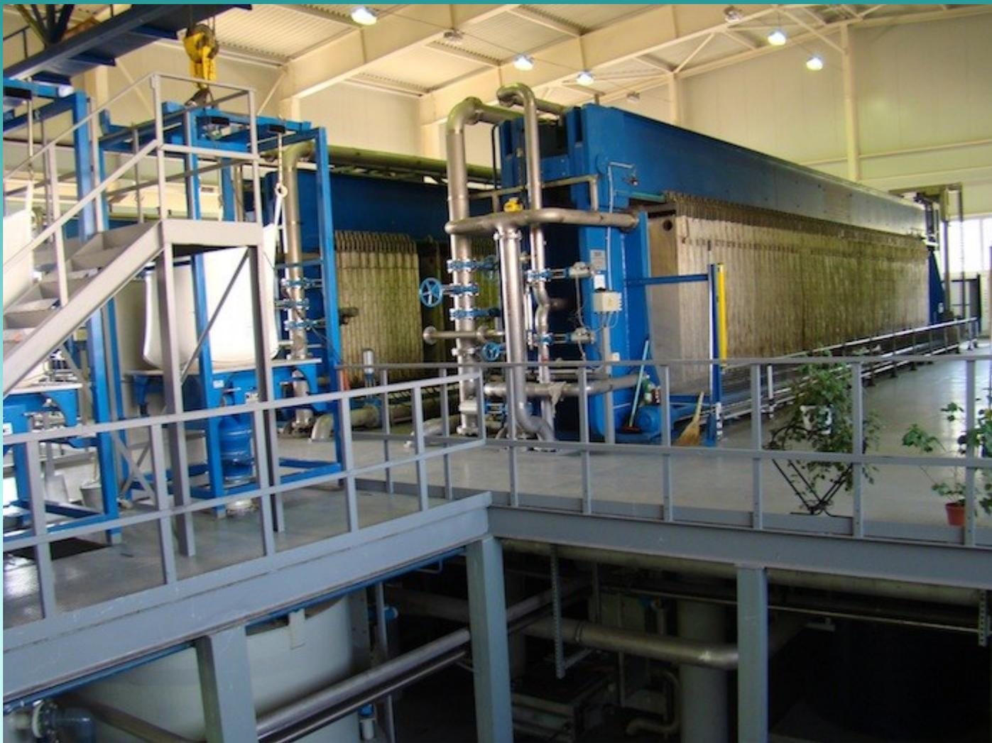
Обезвоживание осадков в фильтрпрессовых камерных установках позволяет уменьшить их объём в 10 – 15 раз, в зависимости от исходной влажности, а последующее термическое обезвреживание (сжигание) даёт сокращение объёма обезвоженного осадка ещё в 4 – 6 раз.
