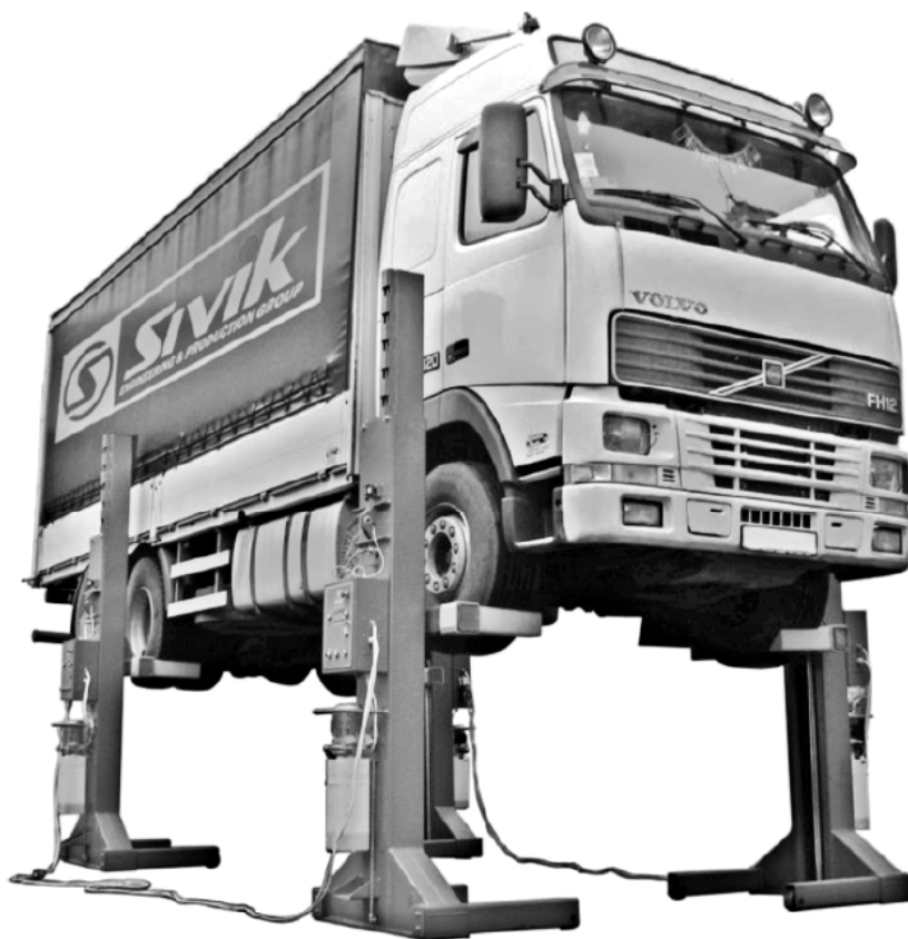
Рис. 10.35. Подъемник-комплект с четырьмя передвижными стойками для грузовых автомобилей и автобусов
