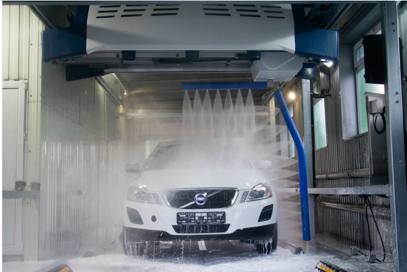
Рис. 10.10. Автоматическая бесконтактная автомобильная мойка
