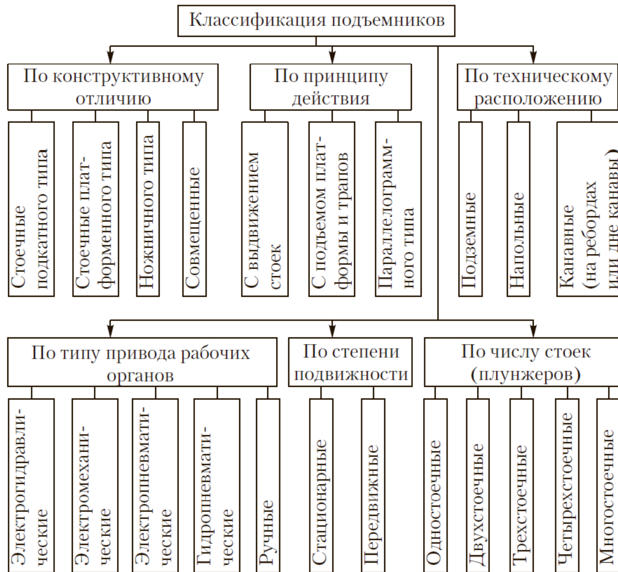
Рис. 10.25. Классификация подъемников, применяемых при ТО и ремонте автомобилей
