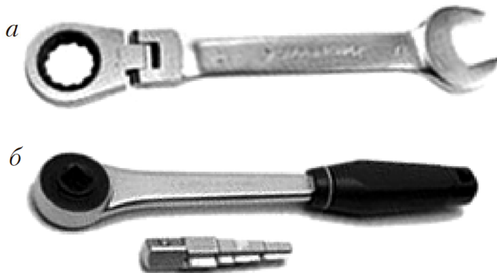
Рис. 10.56. Модификации ключей с храповым механизмом: а — накидной ключ; б — рукоятка для торцевых головок
