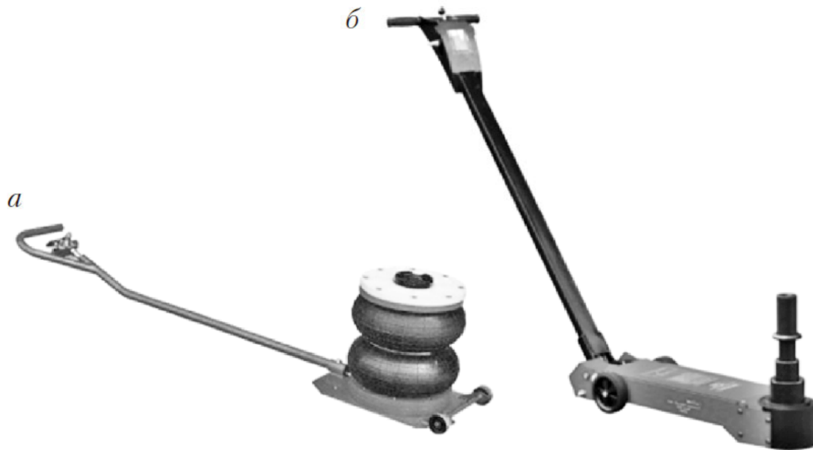
Рис. 10.26. Домкраты: а — пневматический; б — гидравлический
