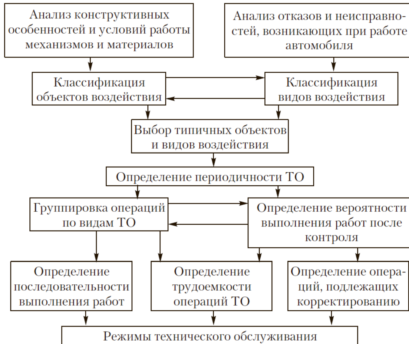
Рис. 6.1. Схема разработки режимов технического обслуживания автомобилей
