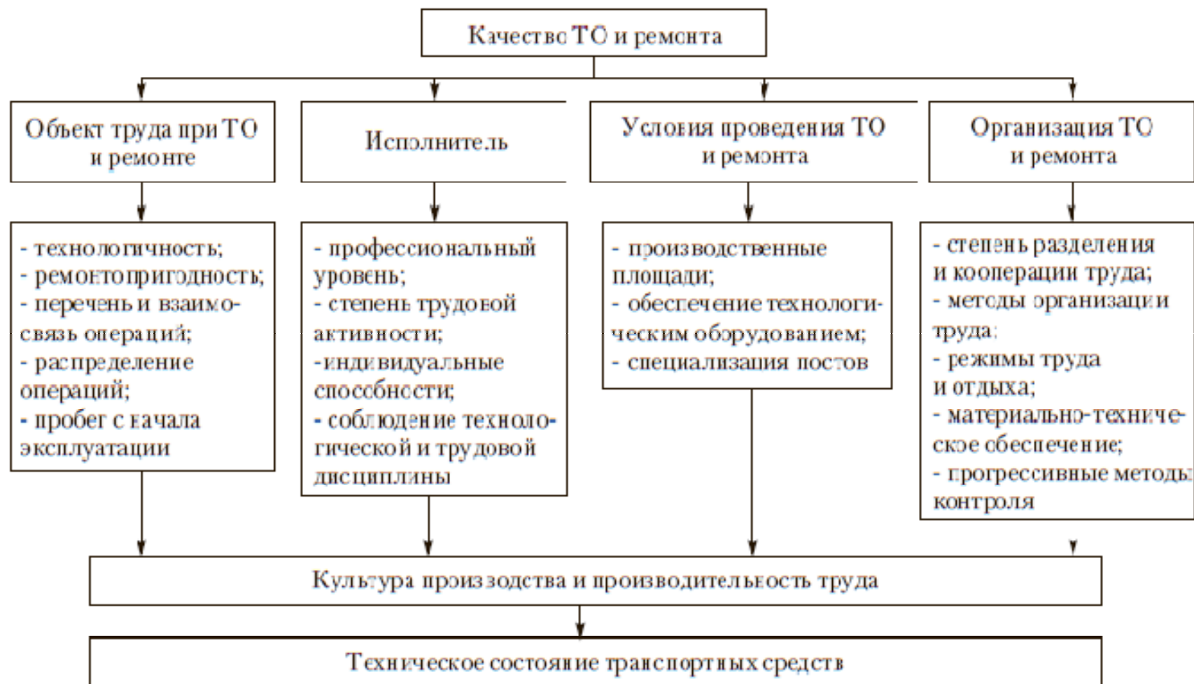
Рис. 6.3. Формирование качества технического обслуживания и ремонта транспортных средств
