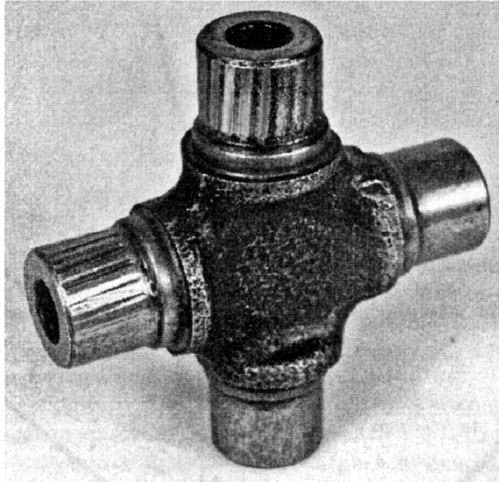
Рис. 2.12. Фреттинг-коррозия цапф крестовины
