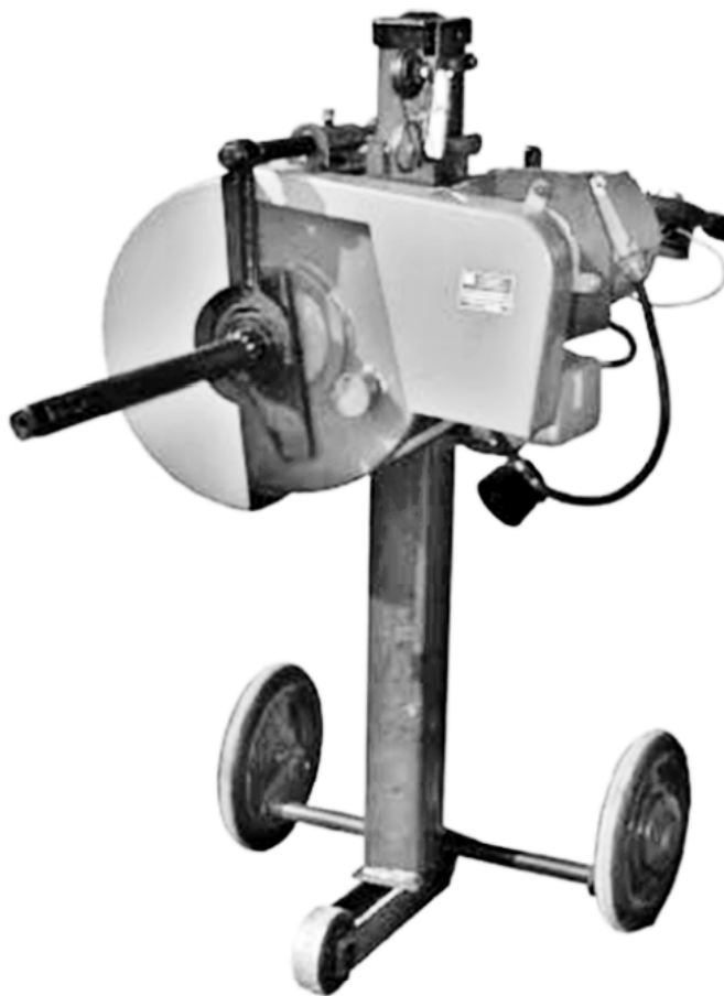
Рис. 10.47. Общий вид электромеханического подкатного инерционно- ударного гайковерта для гаек колес автомобиля И-330
