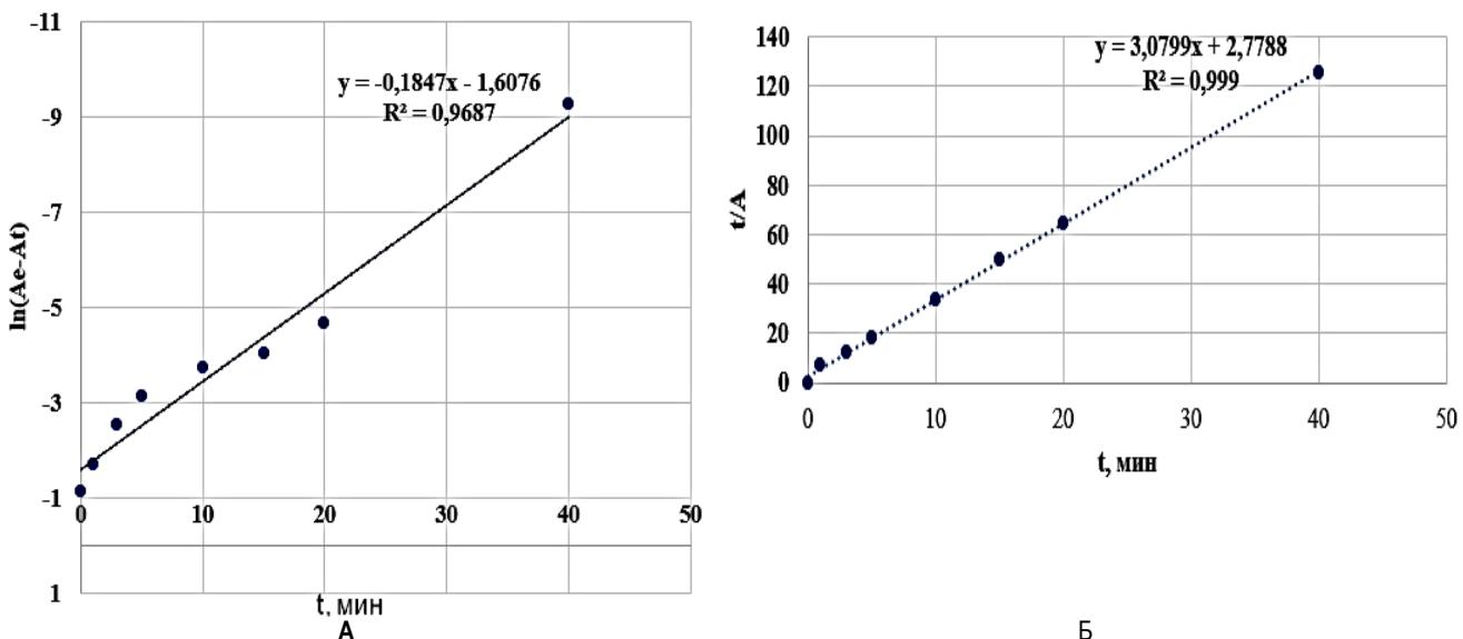
Рисунок 8 – Кинетические кривые сорбции ионов цинка брикетированным торфом в моделях псевдопервого (А) и псевдовторого (Б) порядков
