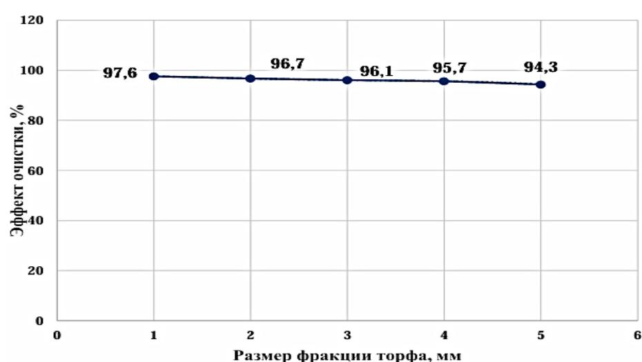
Рисунок 4 – Влияние размеров зерен брикетированного торфа на эффективность сорбции ионов цинка при продолжительности контакта 15 минут
