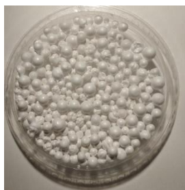
Рисунок 5 – Зерна полистирола, вспененного горячей водой
