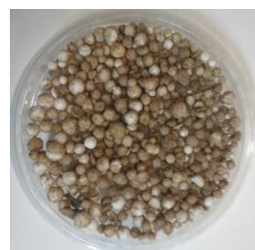
Рисунок 6 – Зерна полистирола, вспененного в среде горячего зернистого материала
