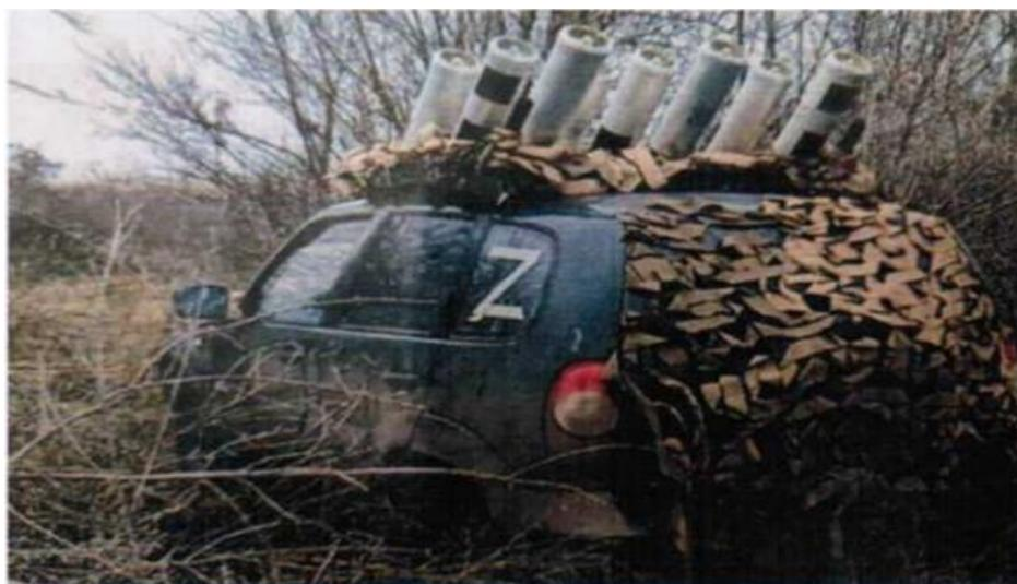
*Рис. 3 Установленные ПКМ с кассетами на автомобиль «Нива»*
