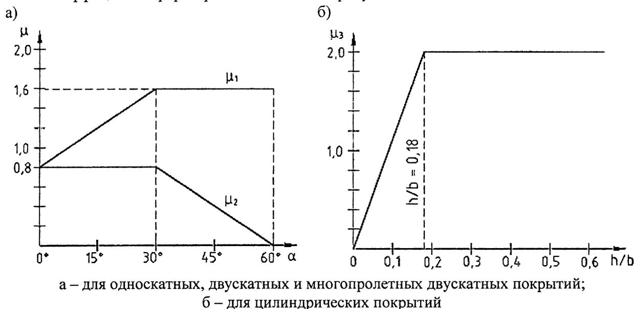
Рисунок 1.1 (рис. 5.1 и 5.5 [34]) – Коэффициенты формы снеговых нагрузок
