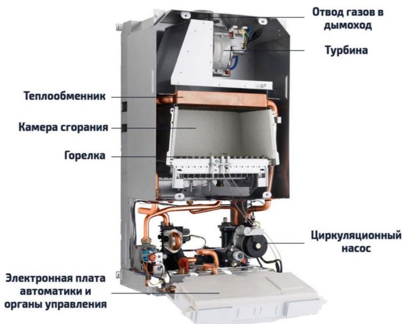
Рисунок 2 – Основные элементы настенного газового котла [3]
