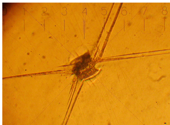
Рис. 1. Картина деформации без приложения МП. \times 200
