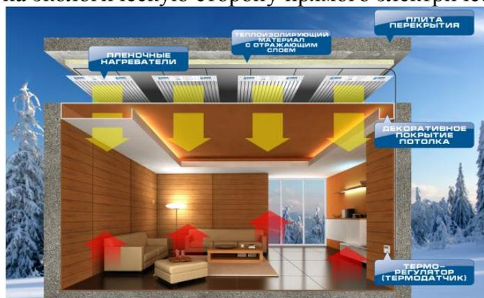
Рис. 5 Процесс инфракрасного излучения в доме
