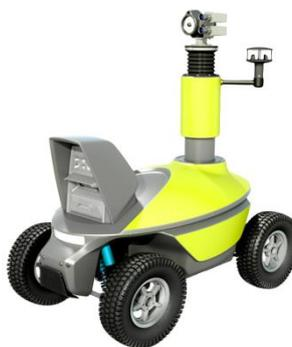
Рис. 2 Робот обнаружения и локализации утечек газа
