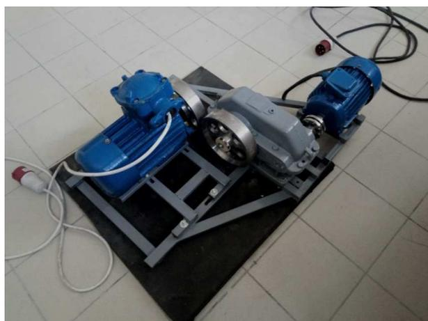
**Рисунок 1** – Лабораторная установка вибровалкового измельчителя
