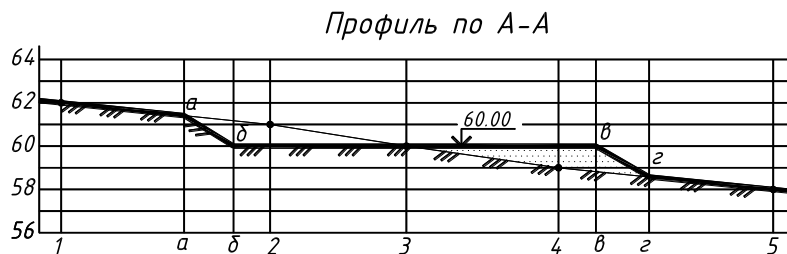
Рисунок 27 – Профиль земляного сооружения
