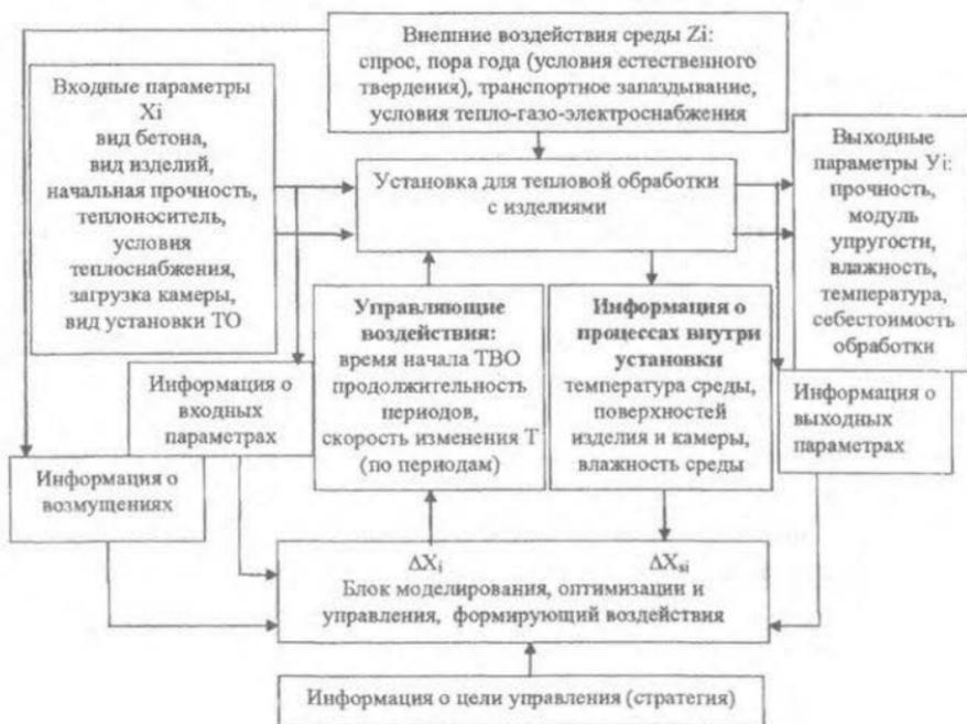
Рис. 1. Схема управляемой системы ТВО
