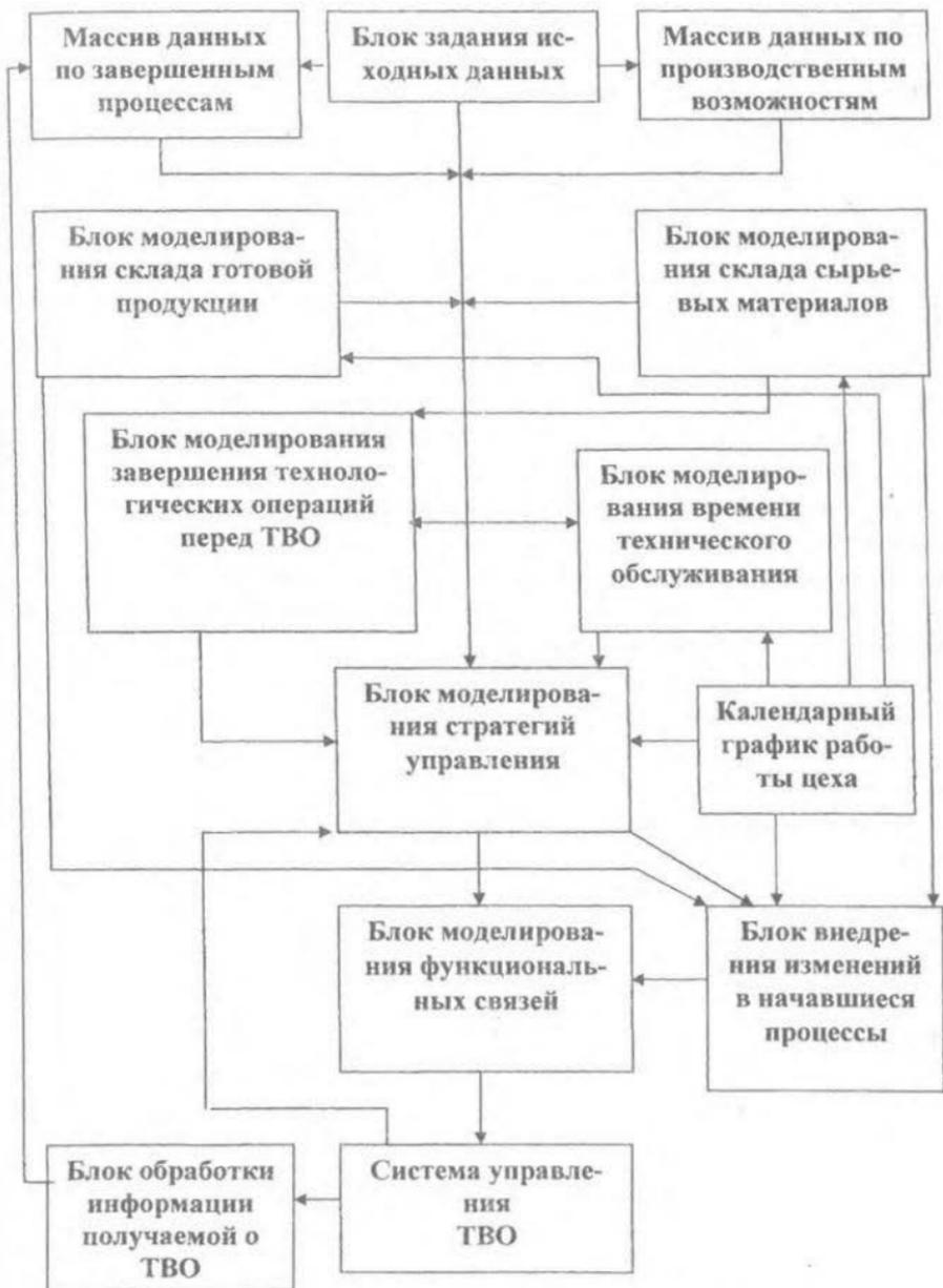
Рис. 2. Структура адаптируемой модели управления тепловой обработкой бетона с изменяемыми критериями функционирования
