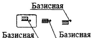
Рисунок 10 – Базисные поверхности стен
