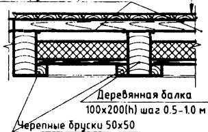
Рисунок 32 – Варианты заполнения межбалочного пространства
