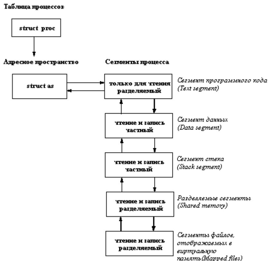
Рисунок 12.1 — Сегментная структура виртуального адресного пространства
