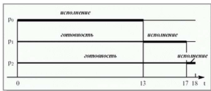
Рисунок 5.2 — Выполнение процессов при порядке p0,p1,p2
