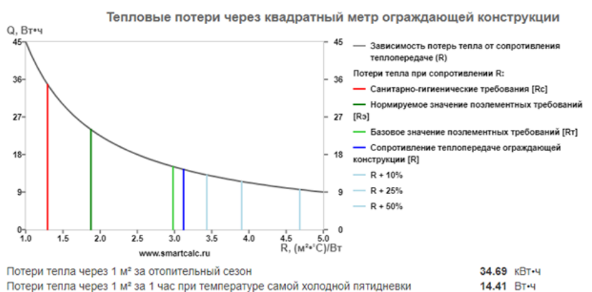
Рисунок 3 — Расчет тепловых потерь через квадратный метр для арболита с направленной укладкой заполнителя с отделочными слоями из керамзитобетона с кладкой блоков на цементно-перлитовый раствор
