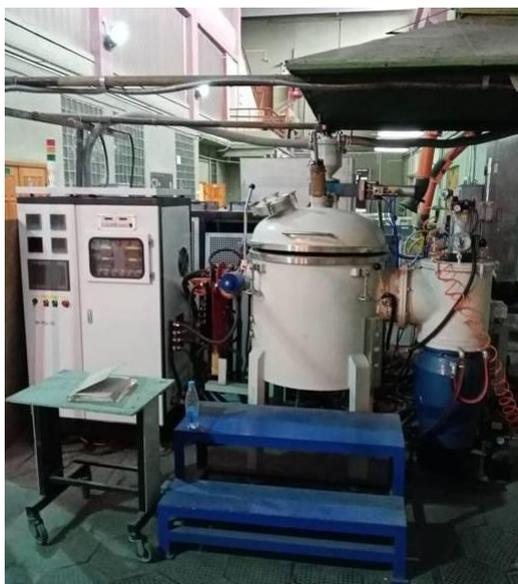
*Рисунок 1 – Вакуумная 10-килограммовая индукционная плавильная установка фирмы Zhengzhou Brother Furnace Co. Ltd*
