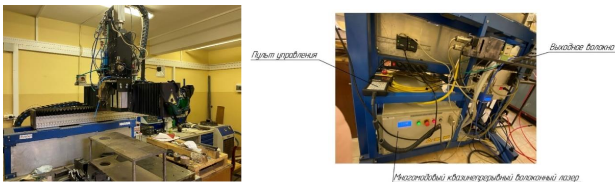
Рисунок 1 – Волоконный иттербиевый лазер непрерывного действия ЛК-1000 фирмы IPG (тип YLR-1)
