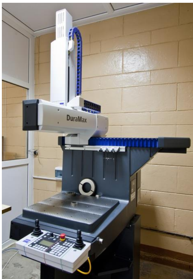
Рисунок 1 – Координатно-измерительная машина DuraMax 5/5/5
