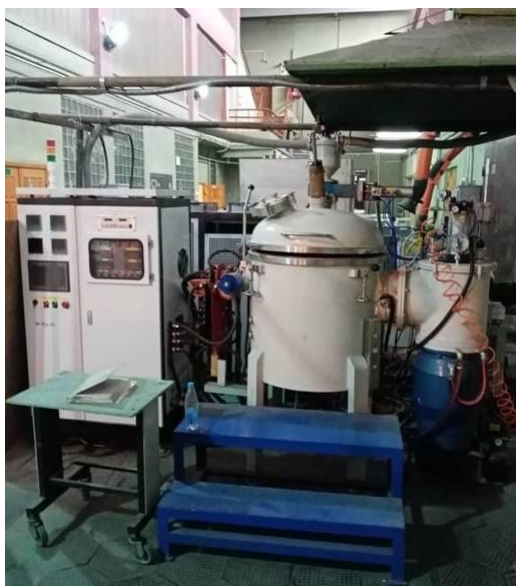
Рисунок 1 – Вакуумная 10-килограммовая индукционная плавильная установка фирмы Zhengzhou Brother Furnace Co. Ltd
