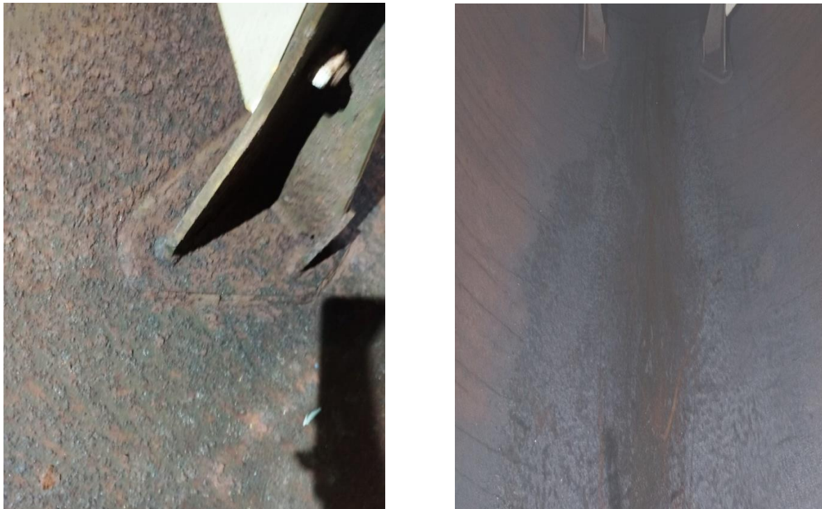
Рисунок 2 – Вид образований пирофорных отложений при коррозионных повреждениях внутренней поверхности газгольдера хранения сжиженного газа
