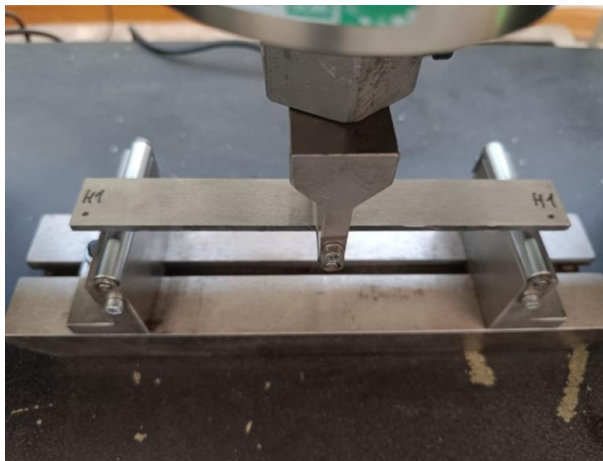
Рисунок 6 – Установка образца на испытательной машине Kason WDW-50
