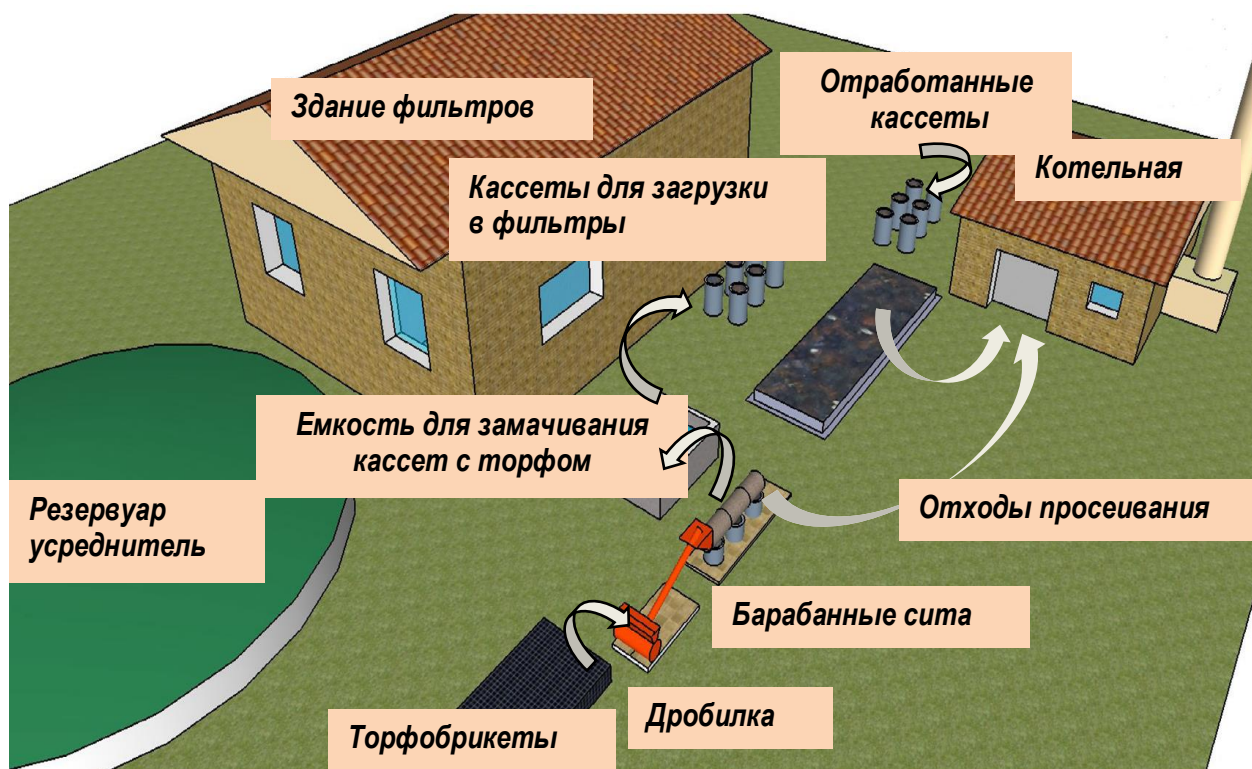
Рисунок 4 – Технология очистки воды от ионов свинца гранулами из брикетированного торфа
