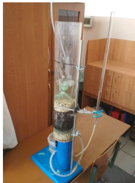
Рисунок 3 – Общий вид установки для исследования сорбционной емкости брикетированного торфа в динамических условиях
