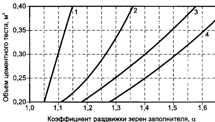
Рисунок 1.2 – Изменение коэффициента раздвижки зерен в зависимости от объема цементного теста
