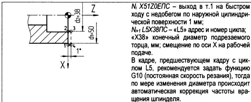
Рисунок 19 – Схема реализации цикла «петля по торцу» L5
