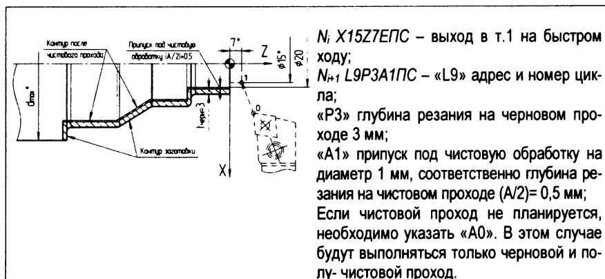
Рисунок 23 – Схема реализации цикла многопроходной обработки заготовок из проката L9
