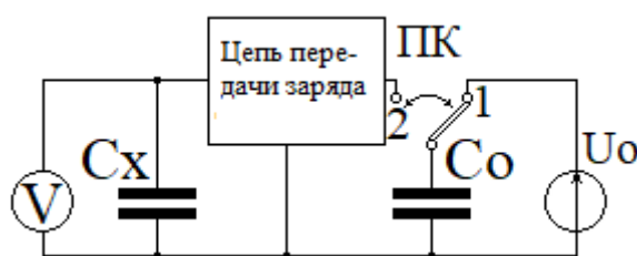
Рисунок 1. Электрическая схема лабораторной установки.
