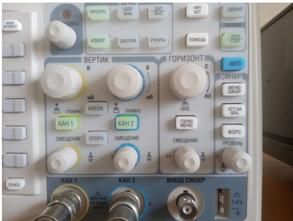
Рисунок 6. Органы управления осциллографом.
