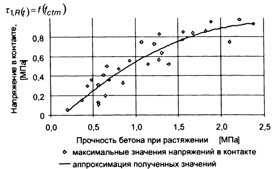
Рис. 6. График зависимости максимальных напряжений \tau_{1,R(t)} , полученных на контакте, от прочности бетона образца на растяжение при сдвиге "бетон — по бетону"
