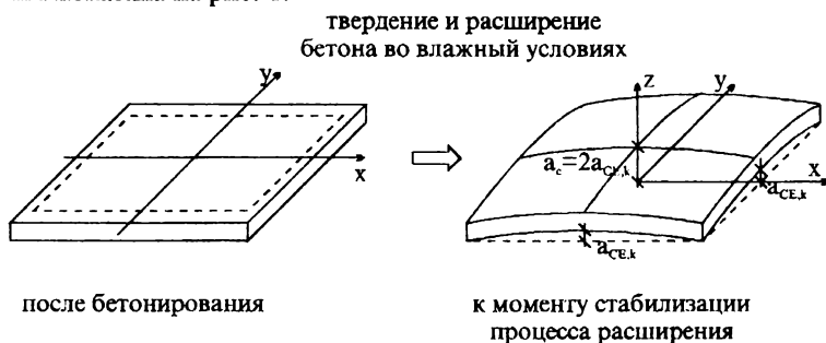
Рис. 1. Схема формообразования в случае оболочки положительной Гауссовой кривизны на стадии расширения напрягающего бетона (при \epsilon_s > 0 ).
