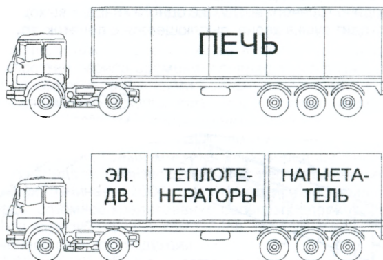
РИС. 4. МОБИЛЬНЫЙ КОМПЛЕКС СУШКИ ЗЕРНА В ТРАНСПОРТНОМ ПОЛОЖЕНИИ
