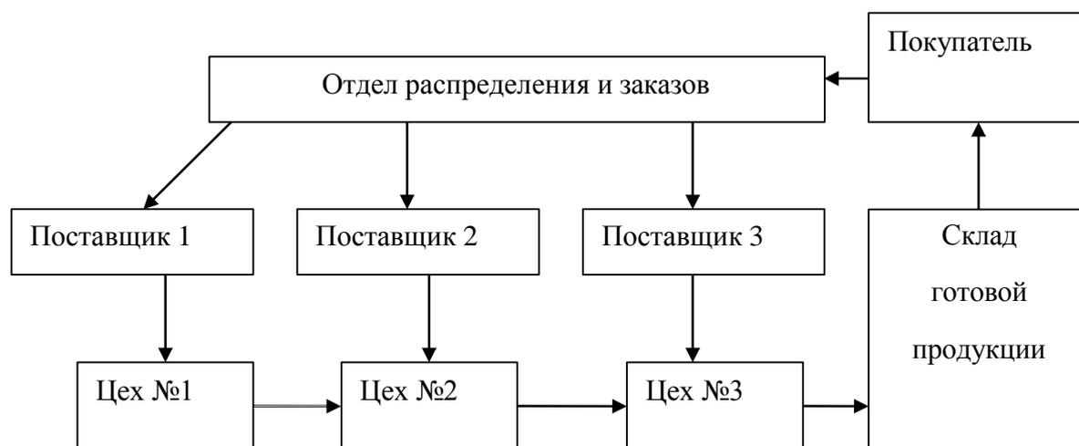
**Рис. 7.3** Схема работы системы «точно в срок»
