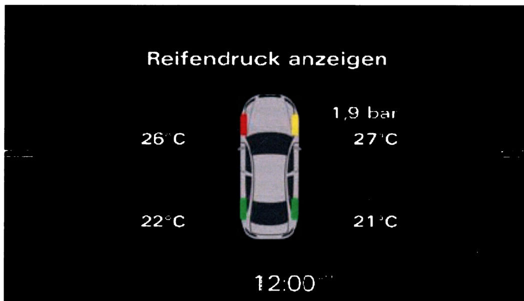
Рисунок 6.5 –Индикация показателей давления воздуха и температуры в шинах
