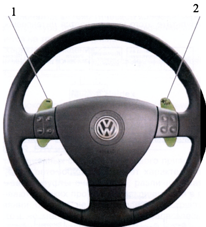
Рисунок 5.7 – Расположение переключателей системы Tiptronic на рулевом колесе
