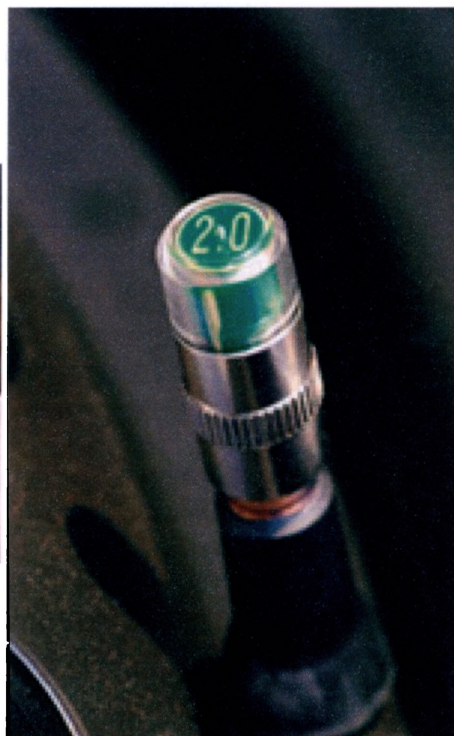
Рисунок 6.1 – Колпачки Easy Control для контроля давления воздуха в шине
