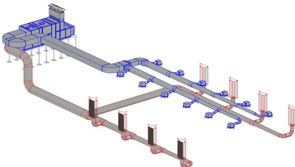
*Рисунок 4 – Схема воздухораспределения вытеснением в помещении конференц зала*
