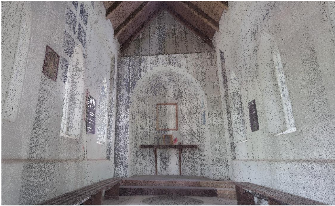
Рисунок 2 – Результаты лазерного сканирования интерьера
