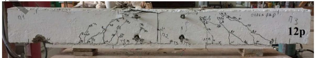
Рисунок 6 – Картина разрушения балок серии БП-II (p)
