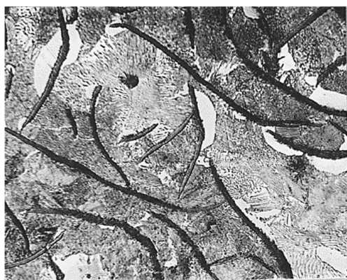
Рисунок 1.4 – Серый чугун на ферритно-перлитной основе
