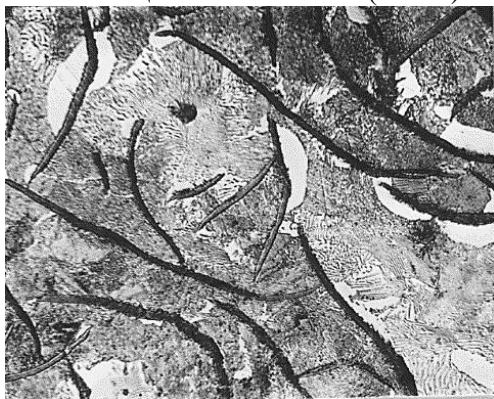
Рисунок 1.4 – Серый чугун на ферритно-перлитной основе
