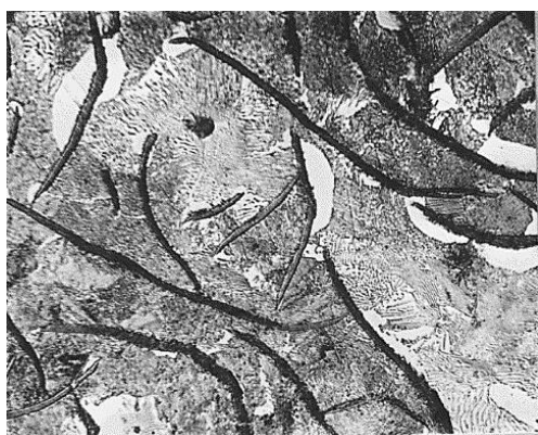
Рисунок 1.4 – Серый чугун на ферритно-перлитной основе
