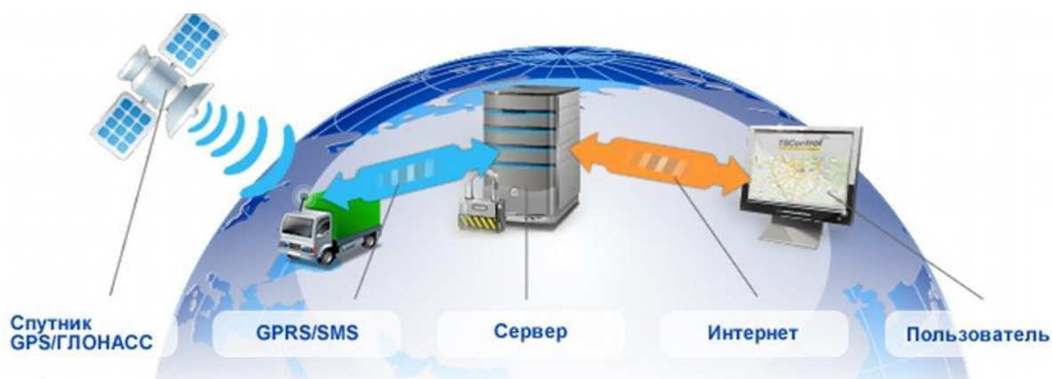
Рисунок 6.1. – Система GPS-мониторинга транспорта
