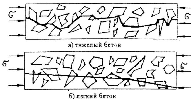
Рис. 3.10. Траектории развития трещин в тяжелом и легком бетонах
