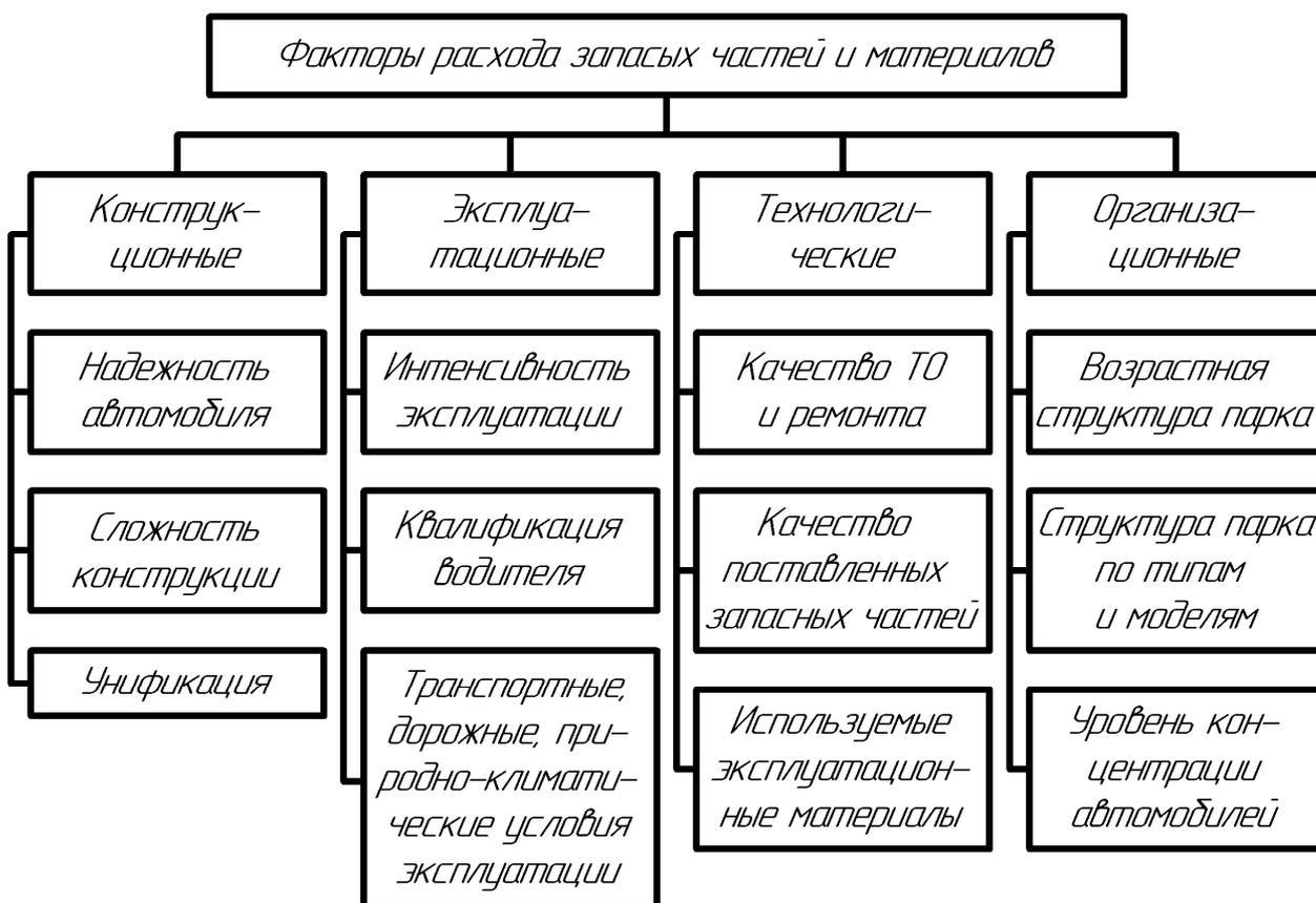
Рисунок 5.1 – Классификация факторов, определяющих потребность в запасных частях и материалах
