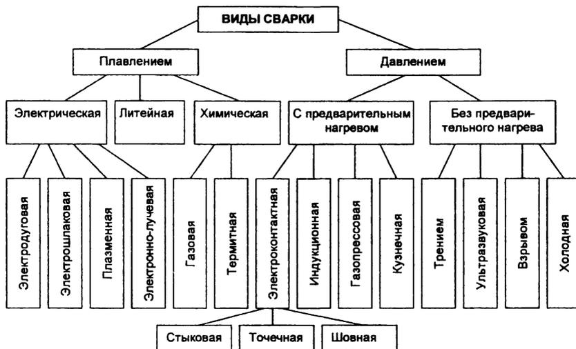
**Рисунок 31 – Классификация основных способов сварки**
