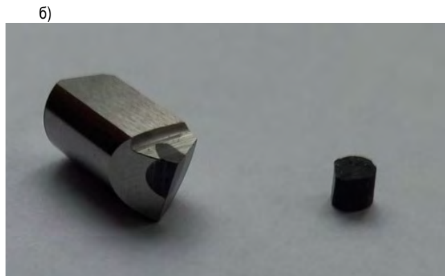
Рисунок 1 – а) пластины из сBN–А и сBN–wBN–AlB 2 /AlN изготовленные в ОИМ НАН Беларуси; б) вставка для реза с впрессованной пластинкой из сBN–wBN–AlB 2 /AlN
