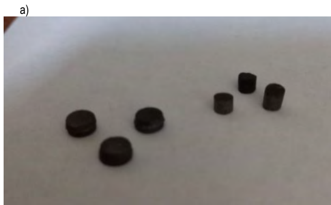
Рисунок 1 – а) пластины из сBN–А и сBN–wBN–AlB 2 /AlN изготовленные в ОИМ НАН Беларуси; б) вставка для реза с впрессованной пластинкой из сBN–wBN–AlB 2 /AlN
