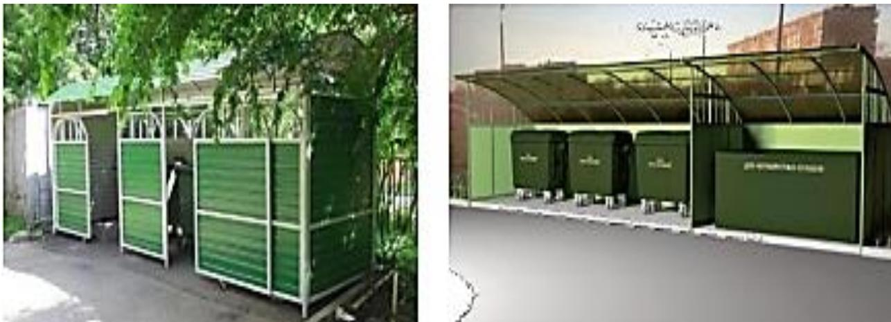
**Рисунок 31 – Площадка ТБО открытого типа с навесом, с закрытыми мусорными баками**
