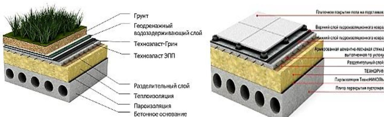
Рисунок 24 – Варианты «пирога» плоской эксплуатируемой кровли
