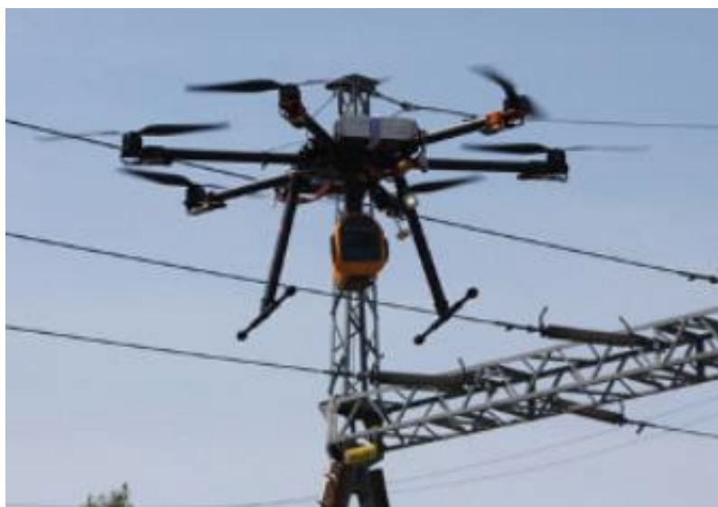
Fot. 7 – Monitorowanie sieci trakcyjnej (urydio: http://www.inzynierbudownictwa.pl/technika,narzedzia_i_maszyny,artykul,zastosowanie_termowizji_z_wykorzystaniem_dronow_w_budownictwie ).
