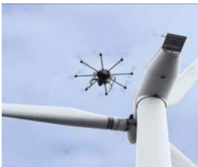
Fot. 10 – Kontrola turbiny wiatrowej (urydio: http://skyinn.pl/obszary-zastosowan/ ).
