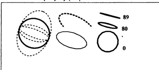
Рис. 4.9. Примеры эллипсов и дуги, построенные с помощью примитива *Ellipse*.
