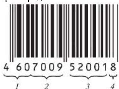
Рис. 1. Расшифровка штрих-кода EAN-13:
