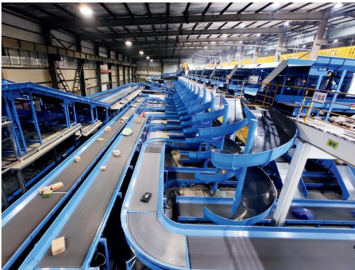
*Рисунок 1 – Автоматизированная система экспресс-сортировки посылок в Китае*
