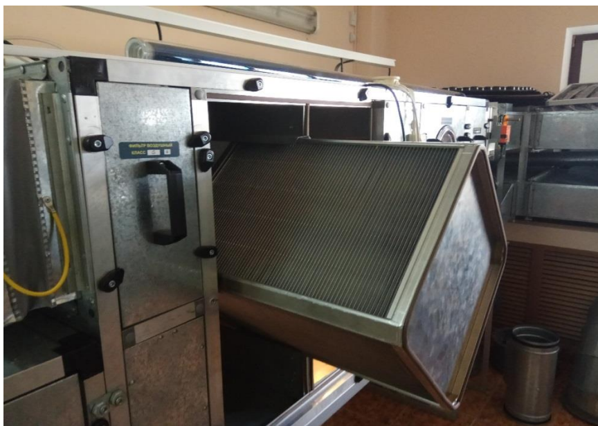
Рисунок 1. Пластинчатый рекуператор в лабораторном стенде.
