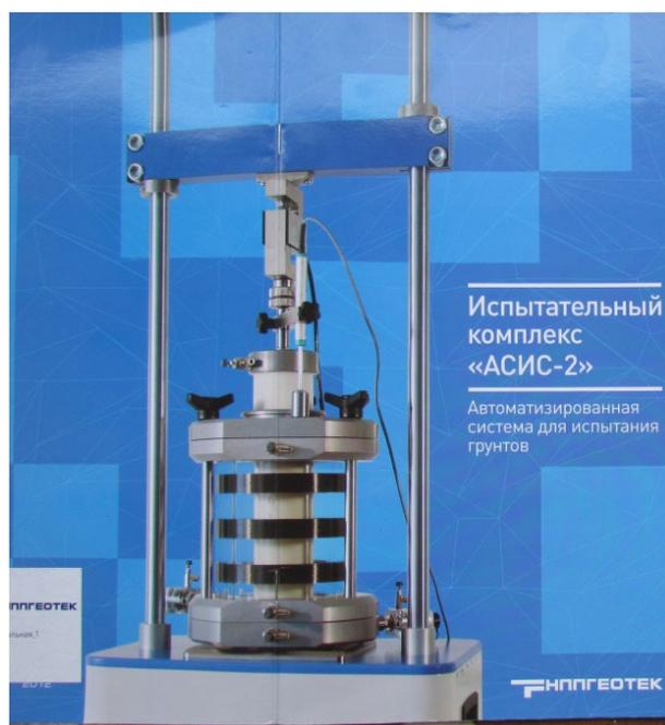
**Рисунок 1 – Общий вид испытательного комплекса АСИС**
