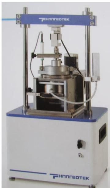
**Рисунок 21 – Установка статических испытаний грунтов на сдвиг**
