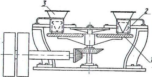
1 – чугунный диск; 2 – образец материала; 3 – воронка для абразивного материала
