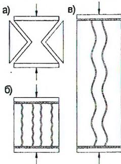
а) кубических; б) кубических, со смазанными опорными гранями; в) призматических
