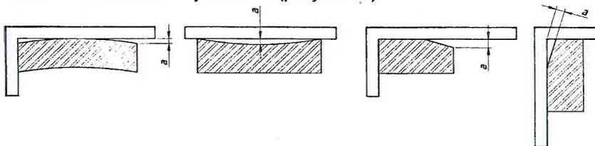
Рисунок 14 – Измерение искривлений граней и ребер кирпича
