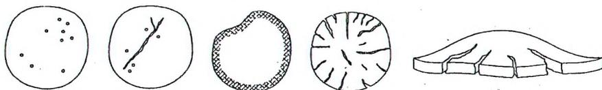
Рисунок 20 – Неравномерность изменения объема цементного теста
