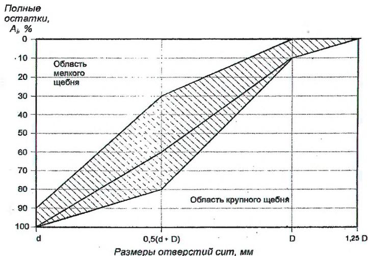
Рисунок 22 – График зернового состава щебня
