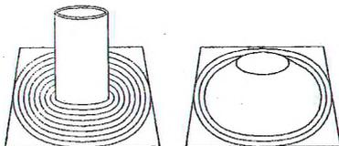
Рисунок 17 – Определение нормальной густоты гипса
