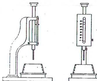
Рисунок 18 – Прибор Вика
