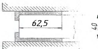
Рисунок 8 – Испытание половинок балочек на сжатие
