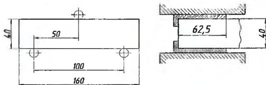
Рисунок 19 – Определение предела прочности образцов гипса на изгиб и на сжатие
