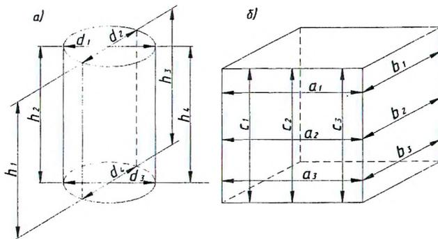
Рисунок 6 – Измерение опытных образцов
