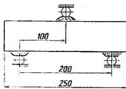
Рисунок 15 – Схема испытания кирпича на изгиб
